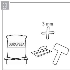
Asegúrese de que cuenta con los siguientes elementos antes de iniciar la instalación: mortero de pega, crucetas plásticas de 3 a 6 mm. de espesor, llana metálica de 6 mm. a 12 mm. (según el formato), martillo de goma color neutro, espátula de goma y cartón corrugado.
