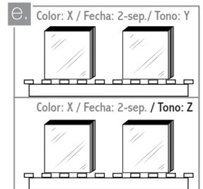
Agrupe las cajas de acuerdo a su tono, lote y fecha de fabricación. Compare visualmente las piezas para verificar la uniformidad de su superficie. Este proceso debe realizarse en exteriores y a la luz solar. Si instala referencias rústicas o marcadas con el sello ARTcoiris de impresión digital, combínelas para establecer homogeneidad en las vetas o los diseños.
