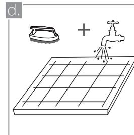
Limpie la cara oculta de la cerámica frotando con un cepillo suave y agua limpia hasta retirar el polvo remanente. Deje que la pieza seque y guárdela en su caja hasta el momento de la instalación. No omita este paso, ya que podría reducir la adherencia del mortero.
