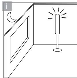
Si trabaja en interiores o durante la noche, ilumine el área de trabajo con lámparas fluorescentes hasta obtener condiciones de luz superiores a las que tendrá en ambiente finalizado. Esto le permitirá detectar errores de instalación con mayor facilidad.
